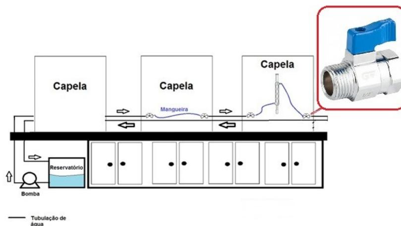
Figura 5: Modelo de sistema para recirculação de água dos condensadores de refluxo
