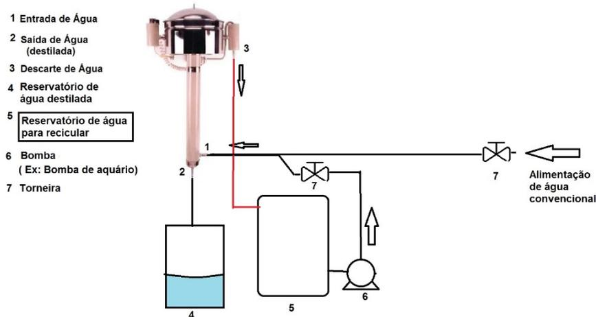
Figura 4: Modelo de sistema para recirculação de água residual do destilador
